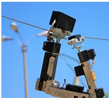
Robot para mantenimiento de líneas de alta tensión
